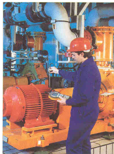
Helyszíni hibakeresés a Vibrotest 60 műszerrel
