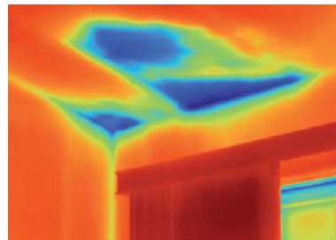
Szigetelés hiánya: Felfedi a magasabb energia számlákhoz vezető szigetelési problémákat.
